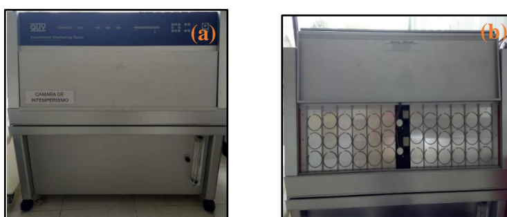
Figura 3.5 Cámara de intemperismo acelerado (QUV) (a): Estructura externa, (b): Distribución de anillos
