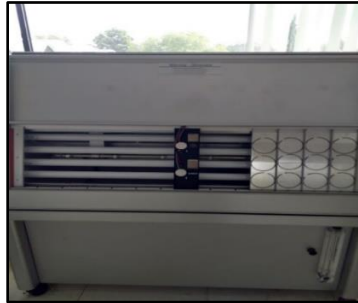
Figura 3.6 Distribución de lámparas UV-A en cámara de intemperismo acelerado
