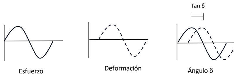
Figura 2.23 Respuesta de desfase de un polímero ante un esfuerzo aplicado (adaptado de TA Instruments, 2024)
