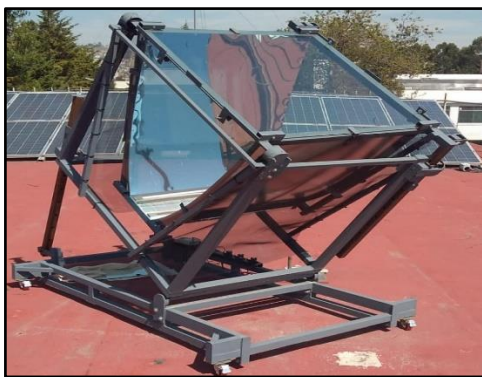
Figura 3.1 Concentrador Parabólico Compuesto (CPC) empleado en estudio de degradación
